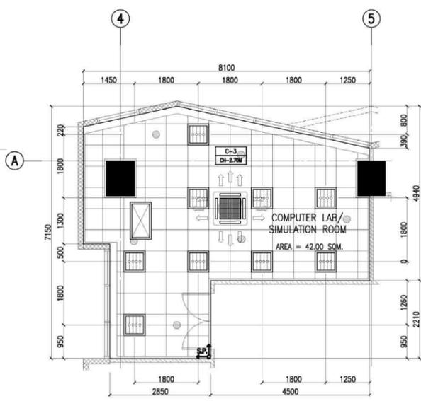
3 22F COMPUTER LAB/ SIMULATION ROOM REFLECTED CEILING PLAN
